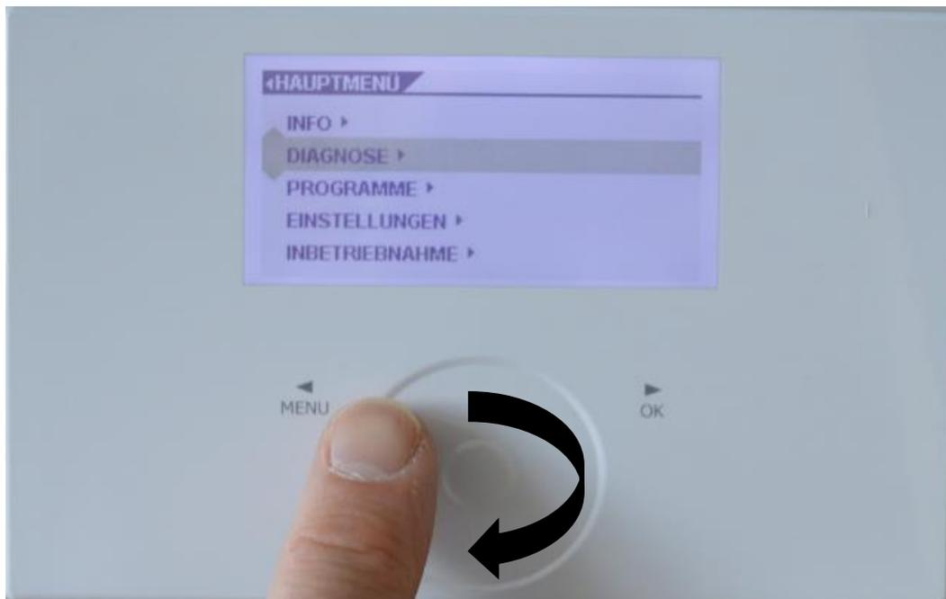
4. Drehen Sie im Bedienkreis nach rechts, bis der Balken auf **MELDUNGSLISTE** steht. Drücken Sie danach auf **OK**.
