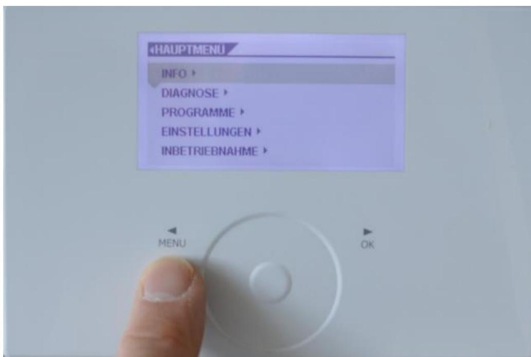
3. Drehen Sie im Bedienkreis nach rechts, bis der Balken auf **DIAGNOSE** steht. Drücken Sie danach auf **OK**.
